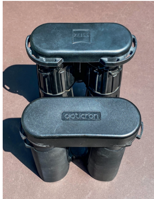
Abb. 3. Vorne das Zeiss Victory SF 10 x 32 mit dem Universal XL Binocular Rain Guard der Firma Opticron; hinten das Dialyt 10 x 40 mit dem klassischen Okulardeckel von Zeiss.
