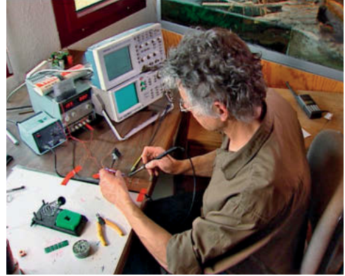
Abb. 2. Beat Naef-Daenzer am Lötten und Testen der selber entwickelten Radiotelemetrie-Sender im alten Vogelwarte-Gebäude. Aufnahme Juni 2004, M. Tschudin.
