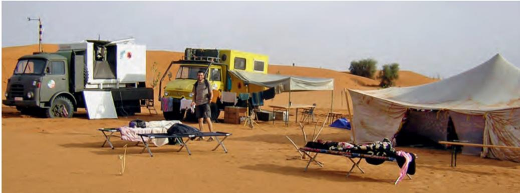
**Abb. 6.** Forschungscamp in der mauretanischen Sahara mit dem auf einem Steyr-Lastwagen montierten und damit mobilen Radar. Weitere Bilder bei Liechti & Schmaljohann (2007). Aufnahme F. Liechti. – *Research camp in the Mauritanian Sahara, the radar mounted on a truck in order to become a mobile station. Further illustrations in Liechti & Schmaljohann (2007).*
