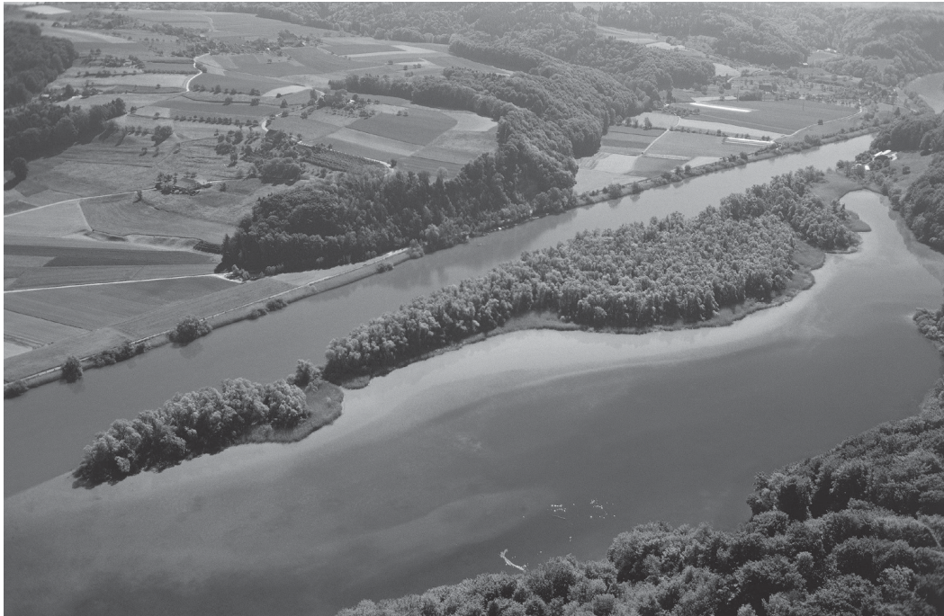
Abb. 1. Der Stausee Niederried flussaufwärts gesehen. Im Vordergrund der flache hintere Seeteil mit den deutlich sichtbaren Ablagerungen entlang der Halbinsel. Aufnahme vom 13. September 2002, BKW-FMB Energie AG. – View upstream on the Niederried reservoir with the shallow backwater in the foreground.
